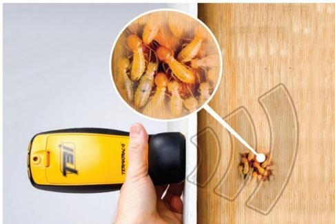
Equipo de alta tecnología que puede detectar y localizar las termitas a través de sensores de humedad, radar y temperatura sin la necesidad de perforar muros y/o suelos, sin interrumpir ni desplazar la actividad de las termitas. Las señales del radar están calibradas para detectar a través madera, ladrillo, albañilería, hormigón, paredes de yeso, plástico, azulejos, alfombra y muchos otros.
