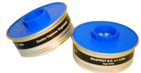
Retiene vapores orgánicos, fabricado con una hojalata tratada con un barniz sanitario que previene la corrosión y deterioro del cartucho. El carbón activo se encarga de retener los contaminantes químicos.
